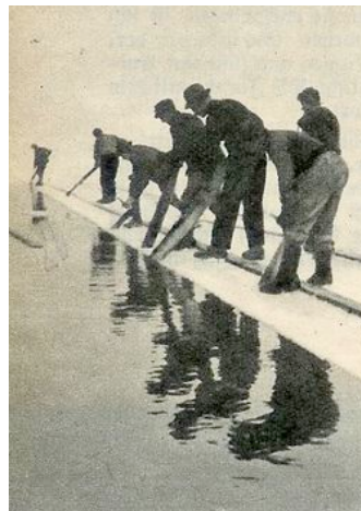
Mit langen Stickeln werden die Eisblöcke auf der Rutsche zur Strasse hochgeschoben.
