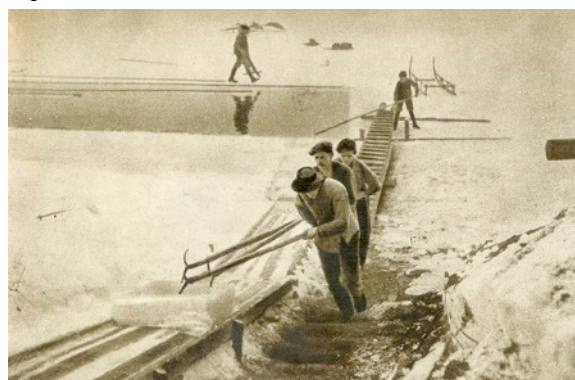
Mit langen Stickeln werden die Eisblöcke auf der Rutsche zur Strasse hochgeschoben.
